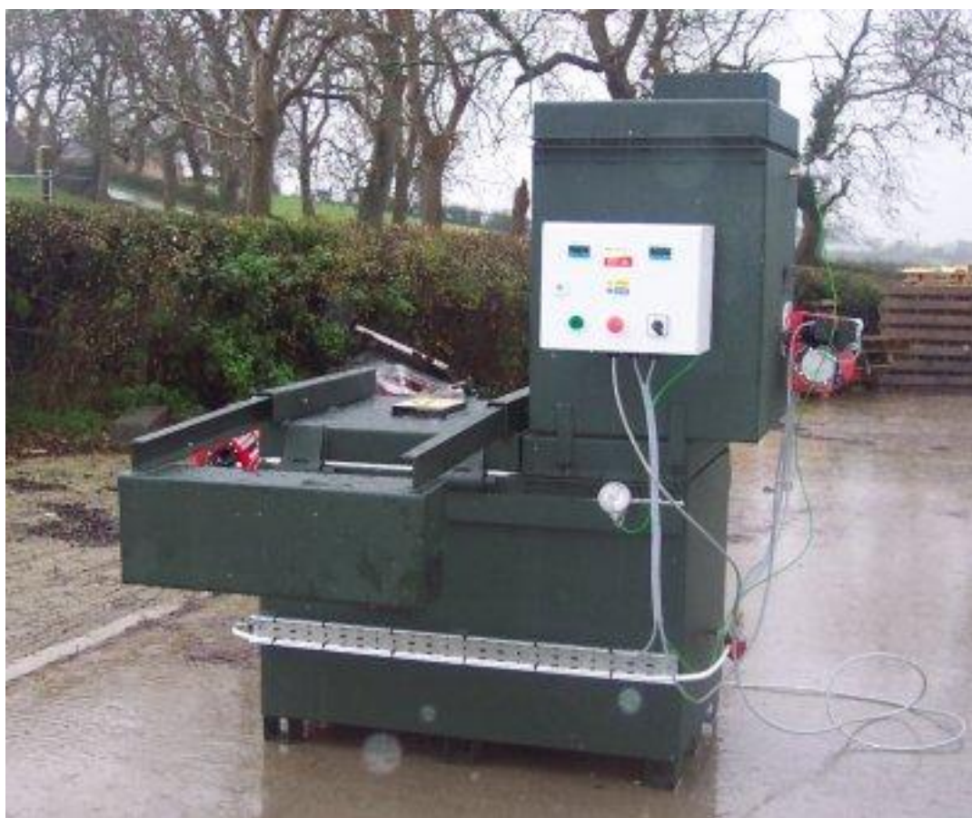
Ryc. nr 3. Piec do spalania martwych zwierząt typu MB240F. (źr. strona internetowa dystrybutora – firmy Vitec Agro).
